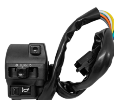
INTERRUPTOR LUZ L. ESQ. FAN 125 2005/2008
